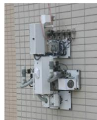
壁面走行型外壁診断装置(試作機)
