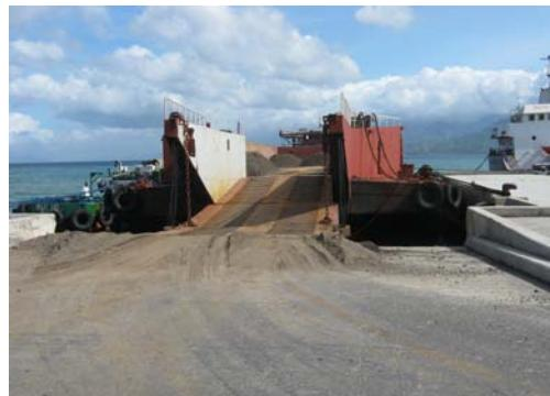
写真-5.36 対岸の港へ建設資材を運ぶ土運船
