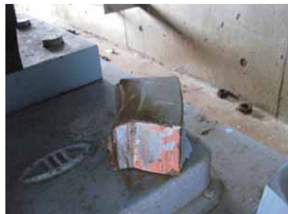
(b) 破断したツメ部
