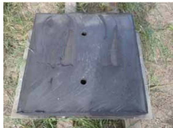
写真-2.3.1.4 ゴム支承の破断面(資料提供：東日本高速道路(株))
