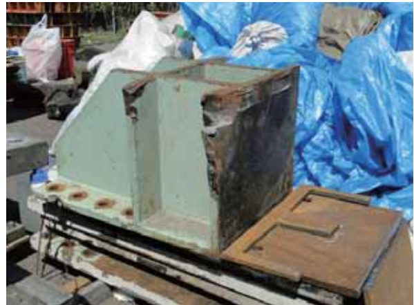
写真-2.2.1.13 破損したジョイントプロテクター
