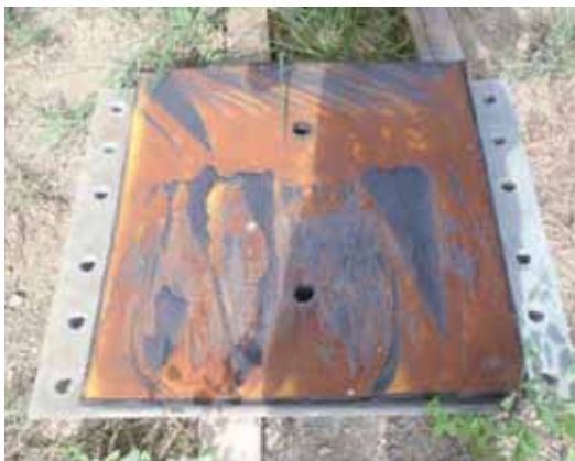
写真-2.3.1.4 ゴム支承の破断面(資料提供：東日本高速道路(株))
