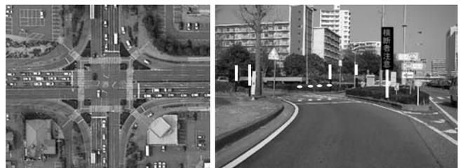
図8 左折導流路交差点と実験時の機器配置イメージ
