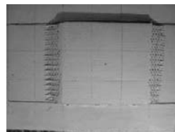
写真-4 押し抜き試験状況 （目地部）
