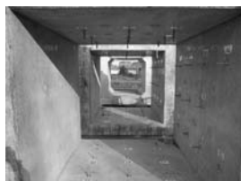
写真-2 模擬損傷供試体
