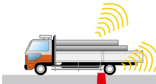
図-5.4 路面の凹凸に起因する衝撃的な音のイメージ
