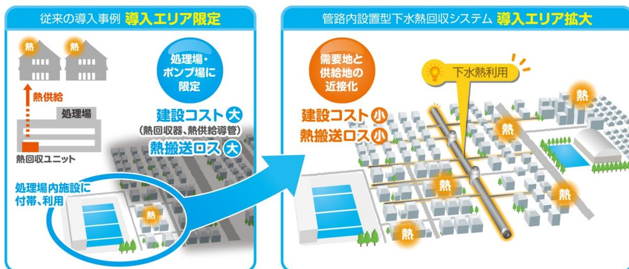
図2-10 下水管路の利用による下水熱利用導入エリア拡大
