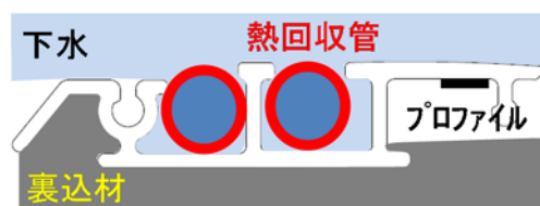
図2-12 熱回収用プロファイル（断面模式図）
