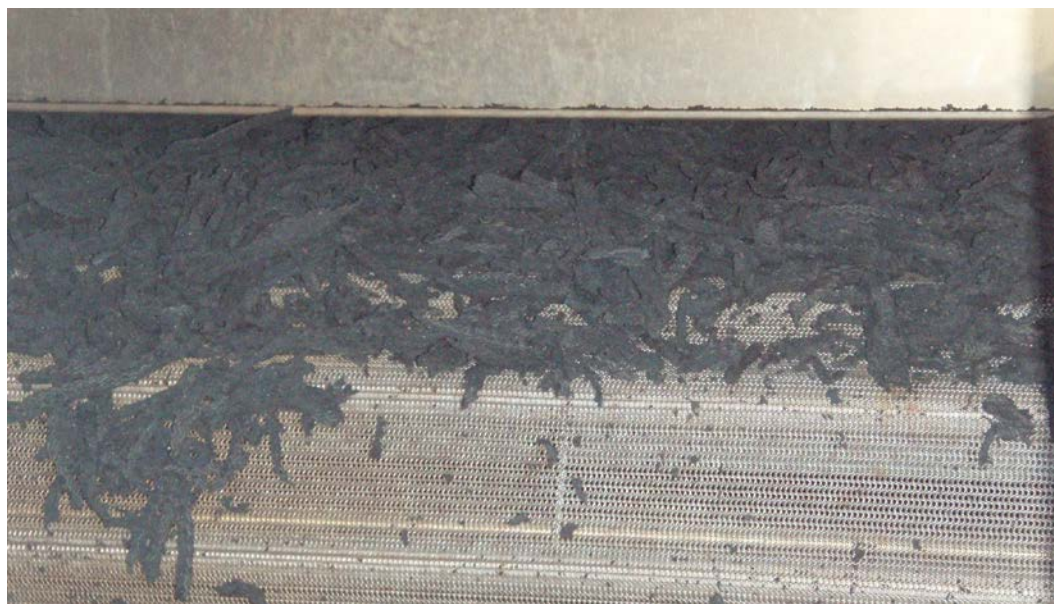
写真 2-3 2 段目以降の乾燥汚泥の移送状況
