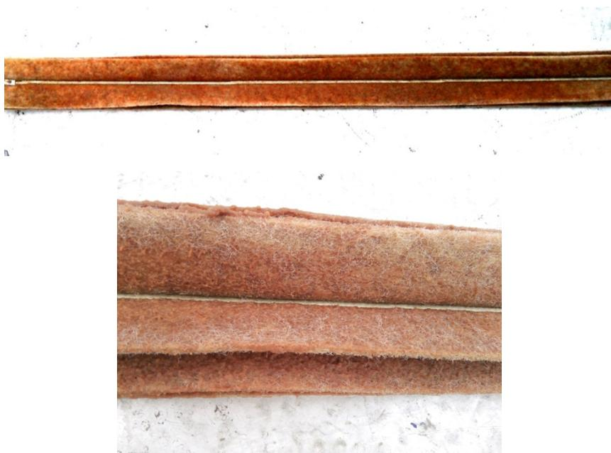
図資 3-13 立上げ試験終了時のアナモックス槽充填担体
