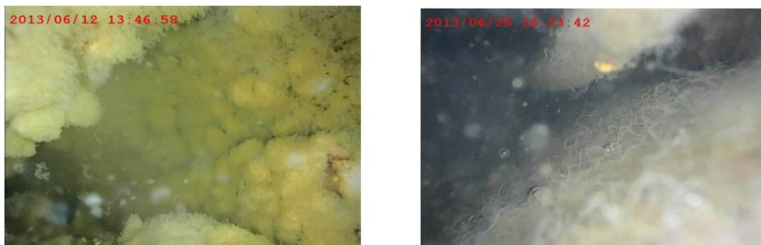
図資 1-43 N<sub>2</sub> ガス洗浄前後の担体表面の状況（左：洗浄前，右：洗浄後）
