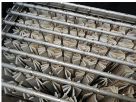
図資 3-11 立上げ試験に使用した担体（アナモックス種汚泥投入前）
