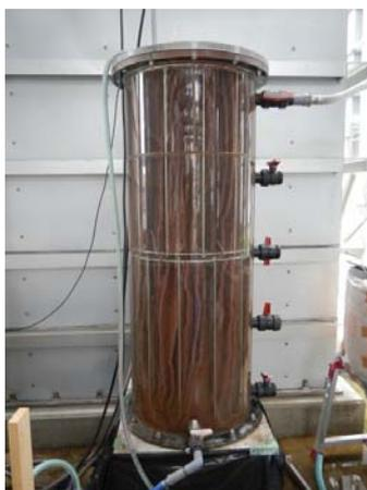
**図資 3-8** ベンチスケールアナモックス装置の外観
