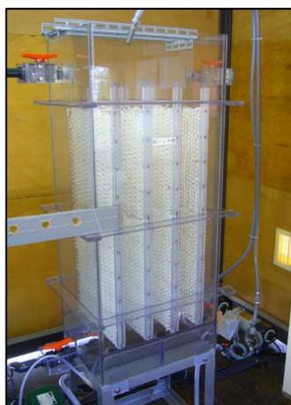
図資 3-14 高負荷有機物除去装置の外観
