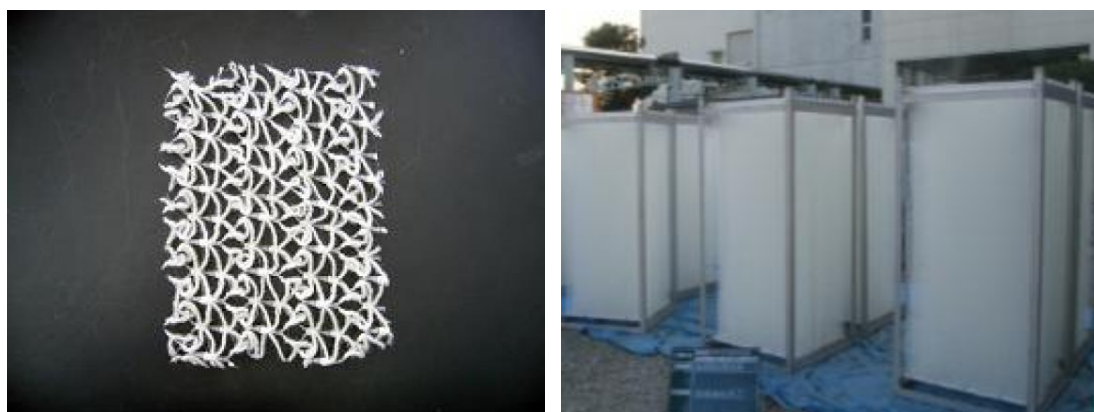
図 4-8 亜硝酸化槽の使用担体（左）と担体ユニット（右）例
