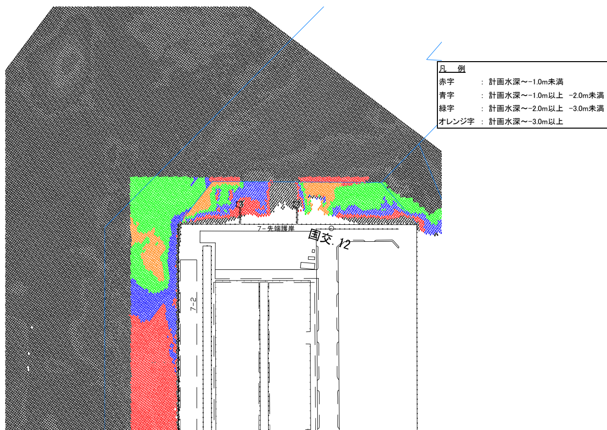
図-A. 14. 323 No.6 7号ふ頭地区先端護岸の地震後の深浅測量結果
