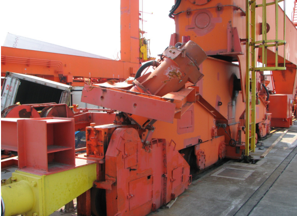
図-A. 12. 364 漂流コンテナによる走行モータの損傷状況（3号機）
