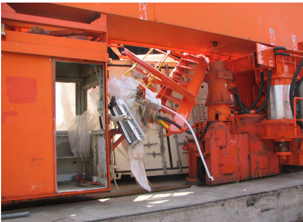
図-A. 12. 365 階段の損傷（3号機）
