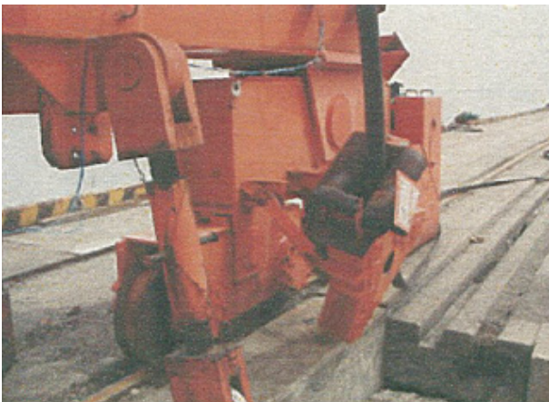
図-A. 12. 355 ガイドリールの損傷 (1号機)
