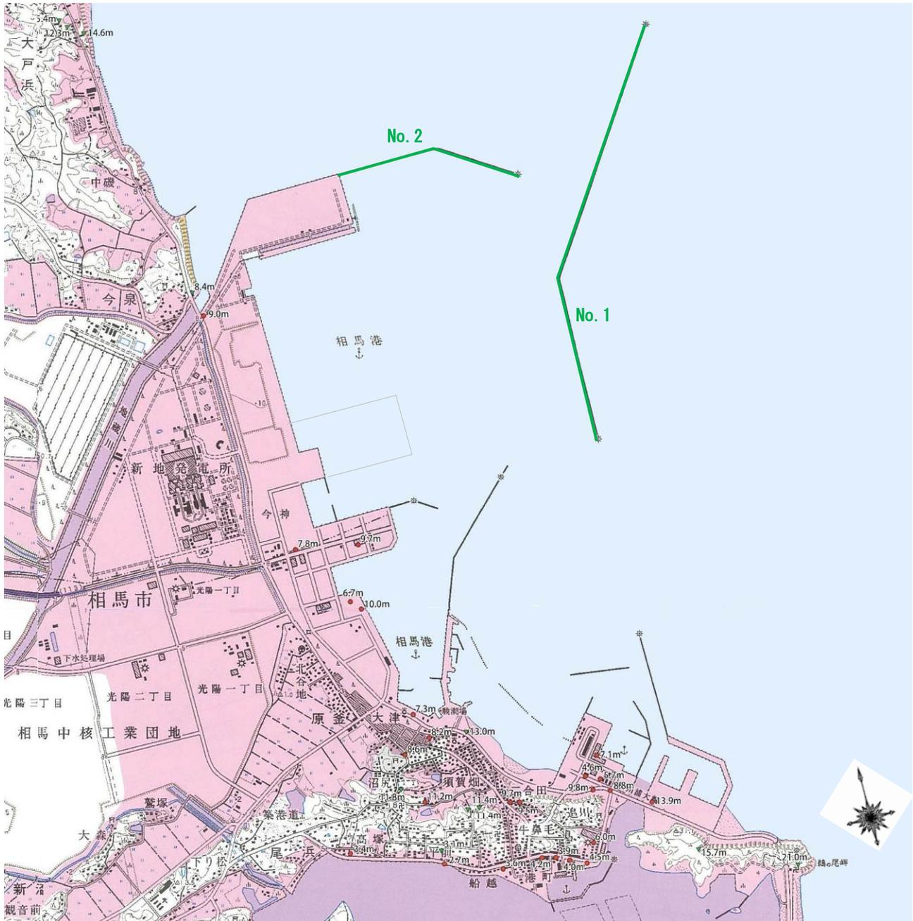
図-3.13.4 相馬港の被災港湾施設 (外郭施設, 直轄分) 1)に加筆
