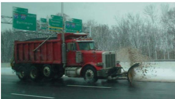
写真 3.5.1 除雪兼凍結防止剤散布車 (ワシントン)
