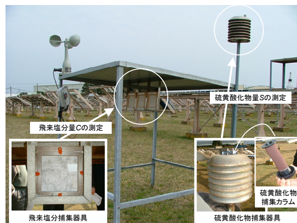
図 2.2.5 一般に行われている側方開放条件の飛来塩分量 C_0 および側方開放条件の硫酸化物量 S_0 の測定風景の例
