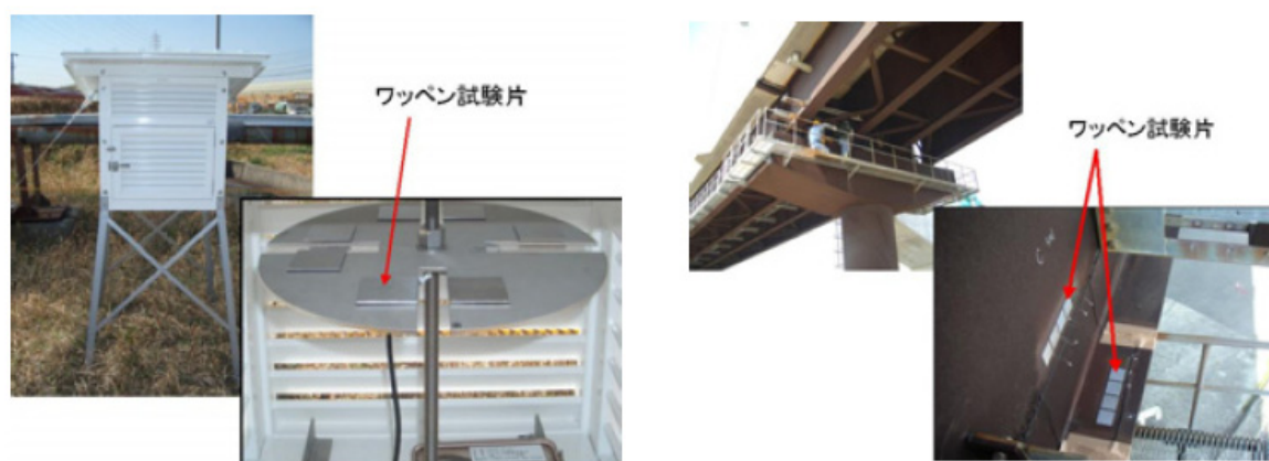
図 2.3.1 ワッペン試験片を用いた環境の腐食性実測方法の例
