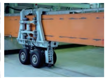
航空機荷重載荷装置
