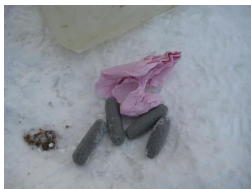
＜模擬汚物＞ 材 質：PVA スポンジ 大きさ：乾燥時φ19、L=70mm
