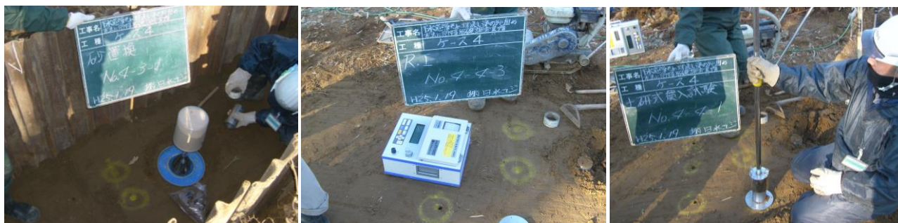
(a) 砂置換法に用いる試験器
