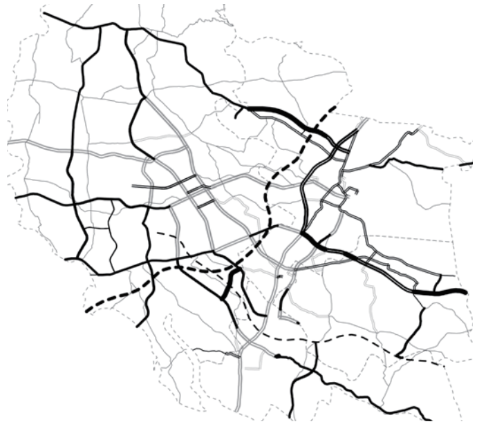
図-1 道路機能に応じた類型区分と土浦・つくば・牛久都市圏の既存道路ネットワークへの適用
