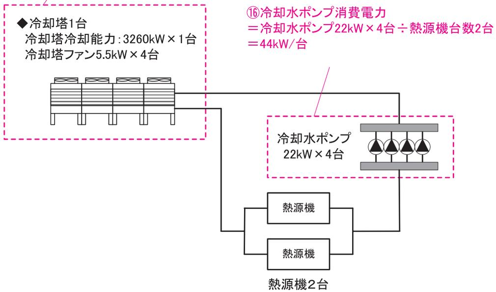
図 1-2-13 熱源機 1 台あたりの冷却塔冷却能力・冷却塔ファンと冷却水ポンプの消費電力の考え方
