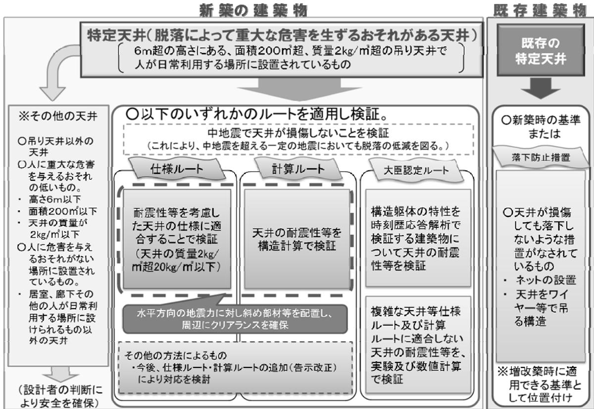
図 2 建築物における天井脱落対策の対象となる天井と検証ルート
