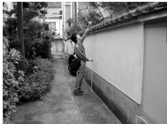
(2) 街路幅員、塀倒壊危険度、階段等の調査
