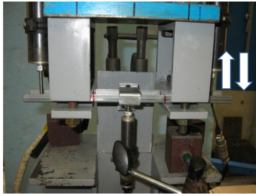
図 3. 3. 3 ハンガーを含む接合部の試験体の取り付け状況の例 (野縁方向に加力する場合、矢印は加力方向)
