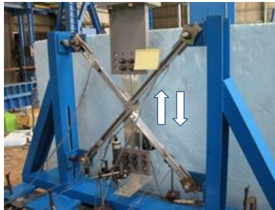
図 3.5.3 試験体の取り付け状況の例 (野縁受け方向に加力する場合、矢印は加力方向を表す)
