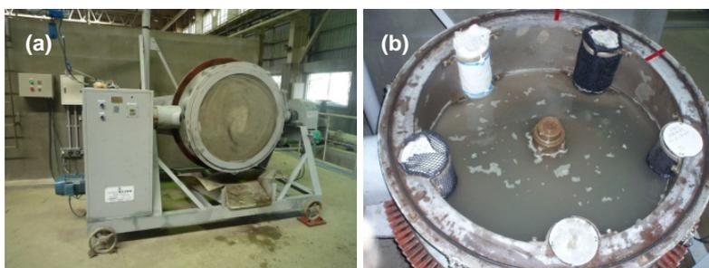
図 I-5.5.2 (a)回転ドラム型試験機, (b)供試体の設置方法
