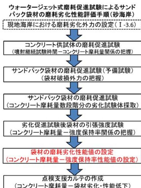
図 I-5.6.1 ウォータージェット式摩耗促進試験による磨耗劣化性能評価手順
