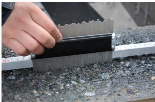
図 I-5.6.9 測定器具と摩耗量の取得
