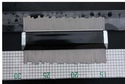
図 I-5.6.10 摩耗量の計測
