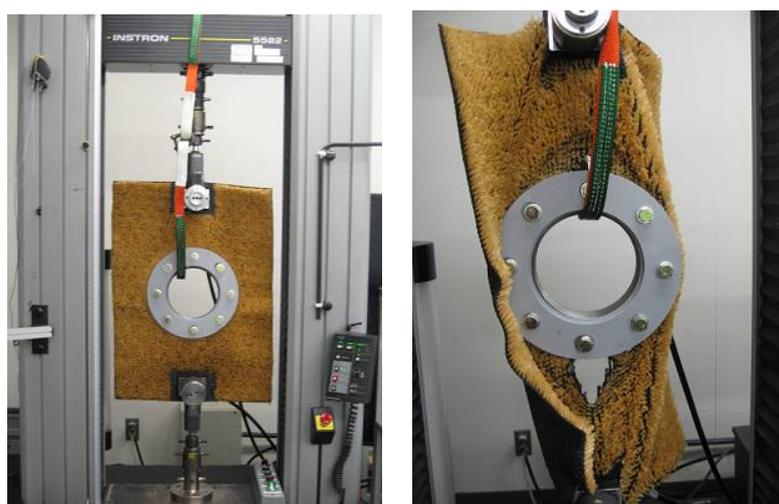
図 I-5.3.2 フランジ注入口の引張強度試験例（JIS L1093 A1 法に準拠）
