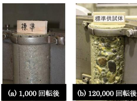
図 I-5.5.3 回転ドラム型試験機によるコンクリートの摩耗状況
