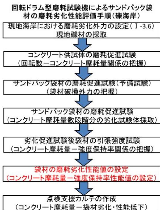
図 I-5.5.1 回転ドラム型摩耗試験機による袋材の磨耗劣化性能の評価手順
