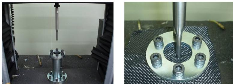
図 I-5.4.8 貫入抵抗試験の実施状況
