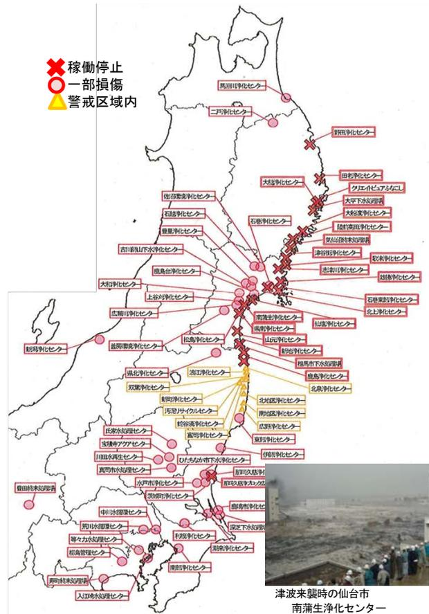
図-2 東日本大震災の下水処理場の被害
