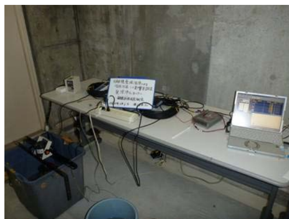
図-2 酸素利用速度試験装置
