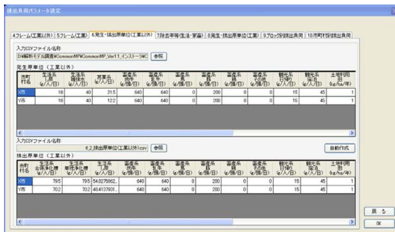
図-4 要素モデルの入力画面の一例（汚濁負荷量原単位入力）
