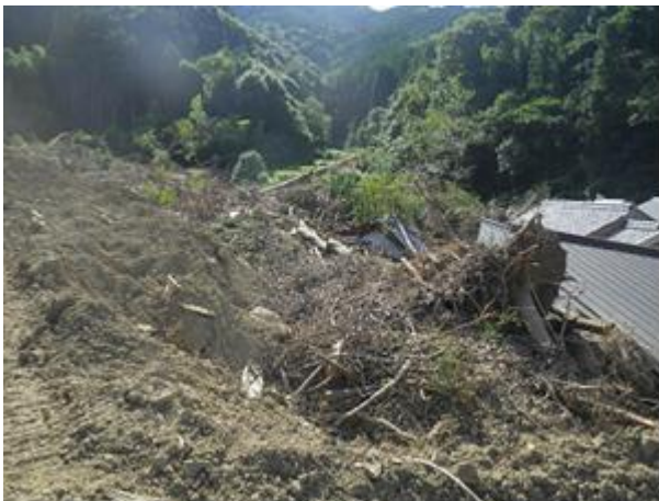
写真-5.2.15 堆積域末端付近側方の状況。最初の段階で広く広がったと考えられる土砂は5cm程度の礫を多く含むが、細粒分も多い。
