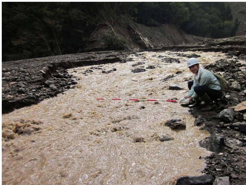
写真-3.7.9 【流量観測地点③】露岩屈曲部の下流約 400m地点での流観の状況 (流水幅約 4m、最大深 0.3m、流速 1.5～1.8m/s、流量約 0.8～0.9m 3 /s、水面勾配約 4° )
