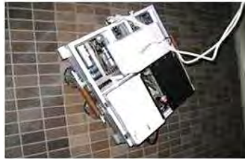
壁面走行型外壁診断装置<試作機> (壁面に吸着しながら移動)
