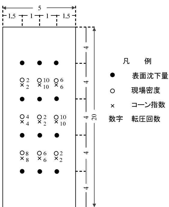
図15-2-2 試験施工の測定項目と測点位配置の一例
