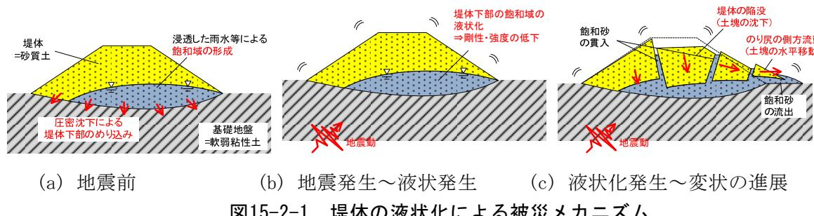
図15-2-1 堤体の液状化による被災メカニズム
