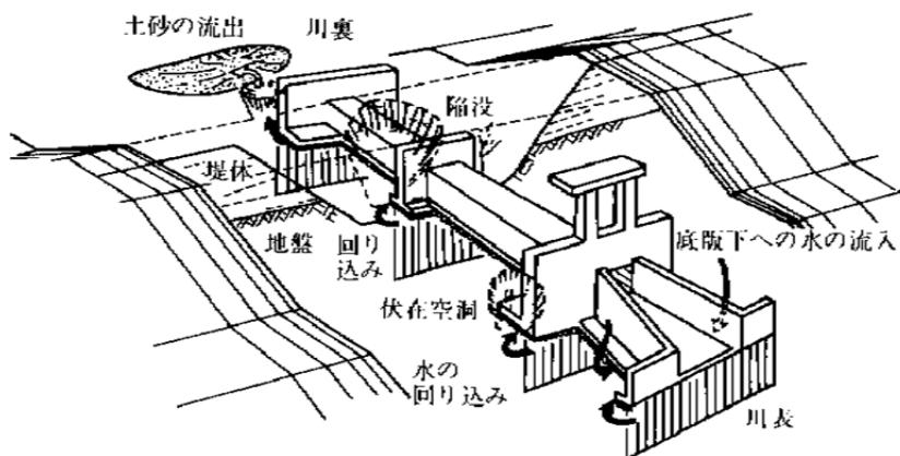
図15-3-3 横管周辺の変状と被災現象概念図
