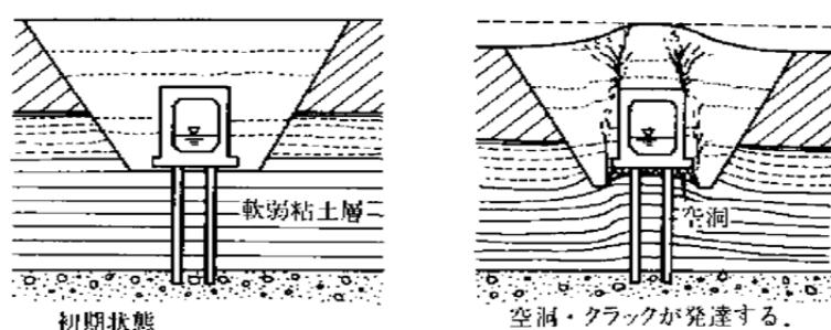
図15-3-1 支持杭基礎の場合の抜け上がりと空洞形成
