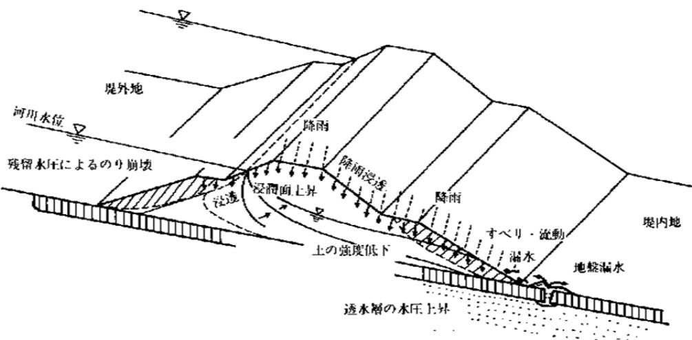
図15-2-3 堤防への降雨、河川水の浸透と漏水
