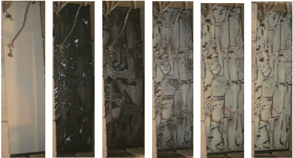
(a) 200°C (b)500°C到達 (c)500°C+5分 (d) 500°C+15分(e) 500°C+30分(f)500°C+60分
