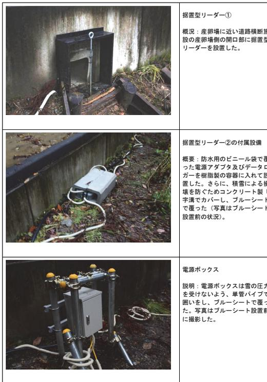
写真-1 据置型マイクロチップリーダーの概要
