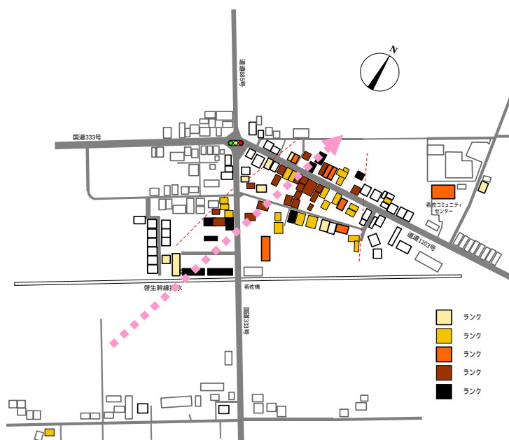
図 6.1-5 佐呂間竜巻（2006）の強風被災度ランク別の頻度分布（矢印は竜巻中心部の経路） 6.6)
