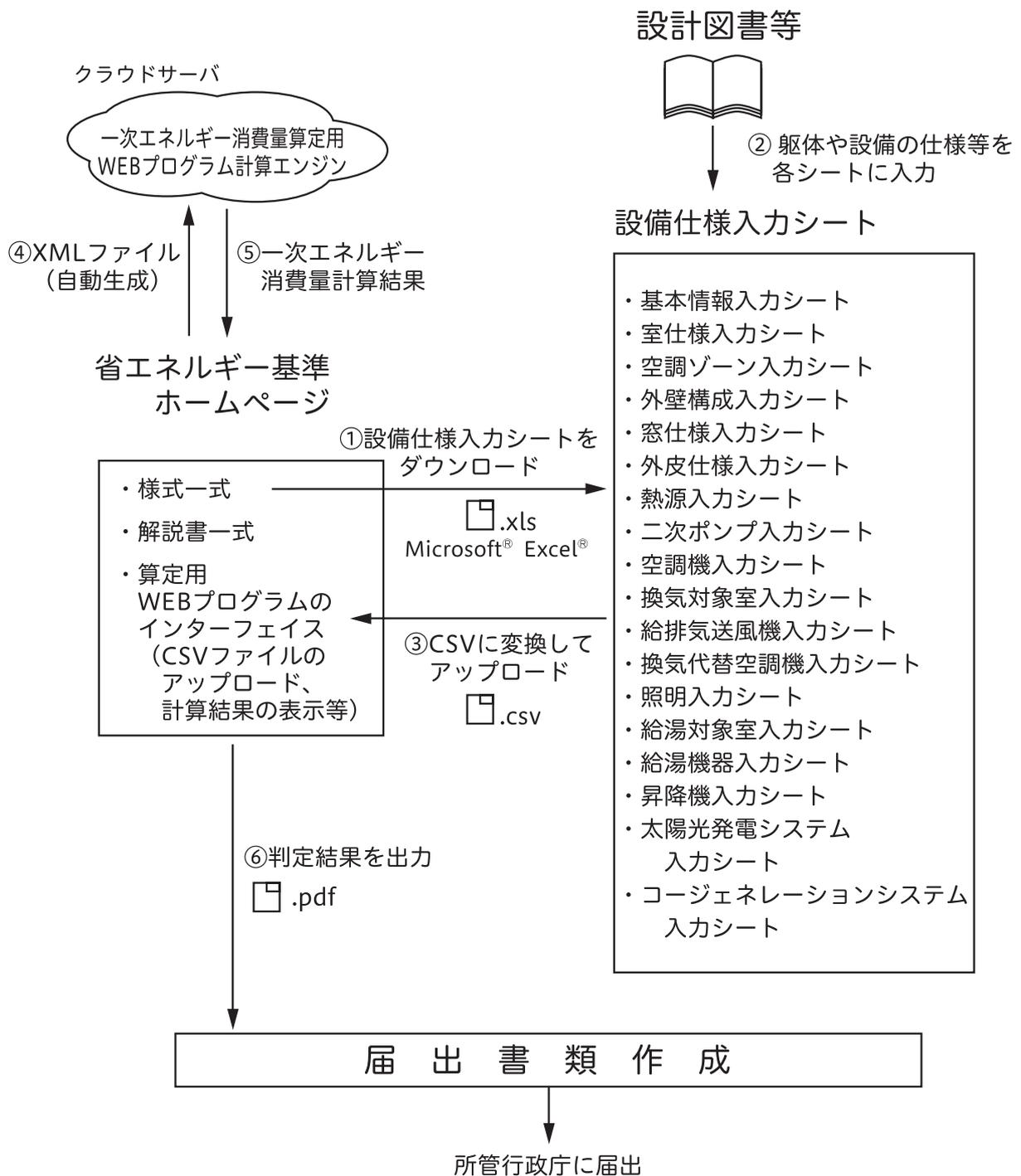
図 -a 設計一次エネルギー消費量の算定および届出の流れ
