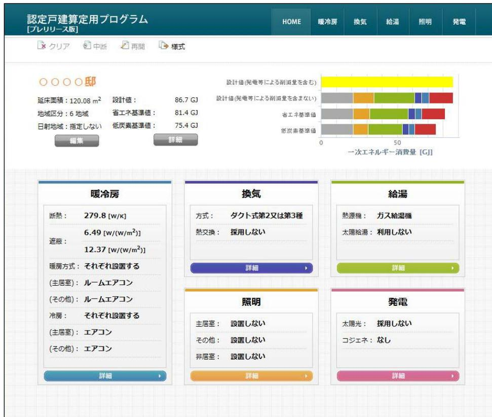
「②用途毎の入力概要表示エリア」には、暖冷房、換気、照明、給湯、発電毎の入力情報の概要が表示される。各表示欄下部の [詳細] ボタンをクリックすると、それぞれの用途の設備の入力タブに移動する。
