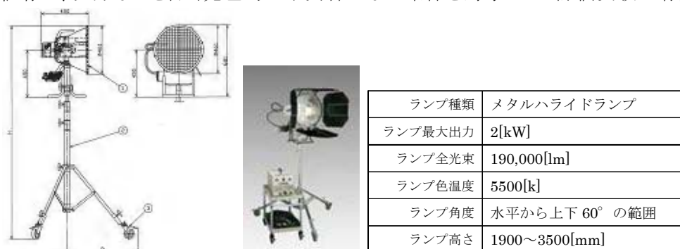
図 3.6.3 導入した直射光を模擬する人工太陽用光源 7)
