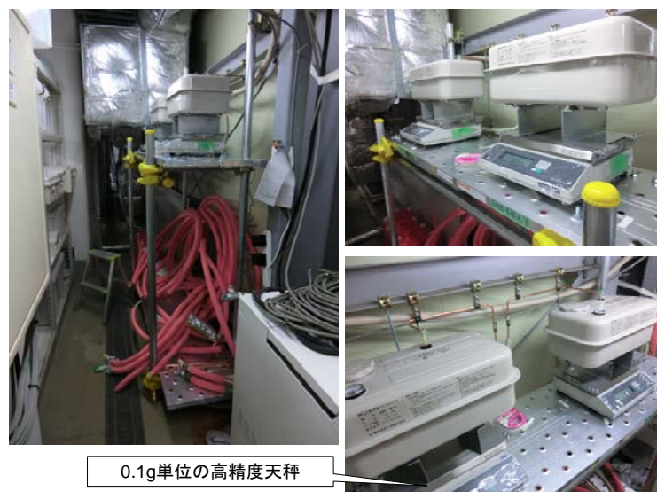
図 3.3.80 石油重量の計測状況
