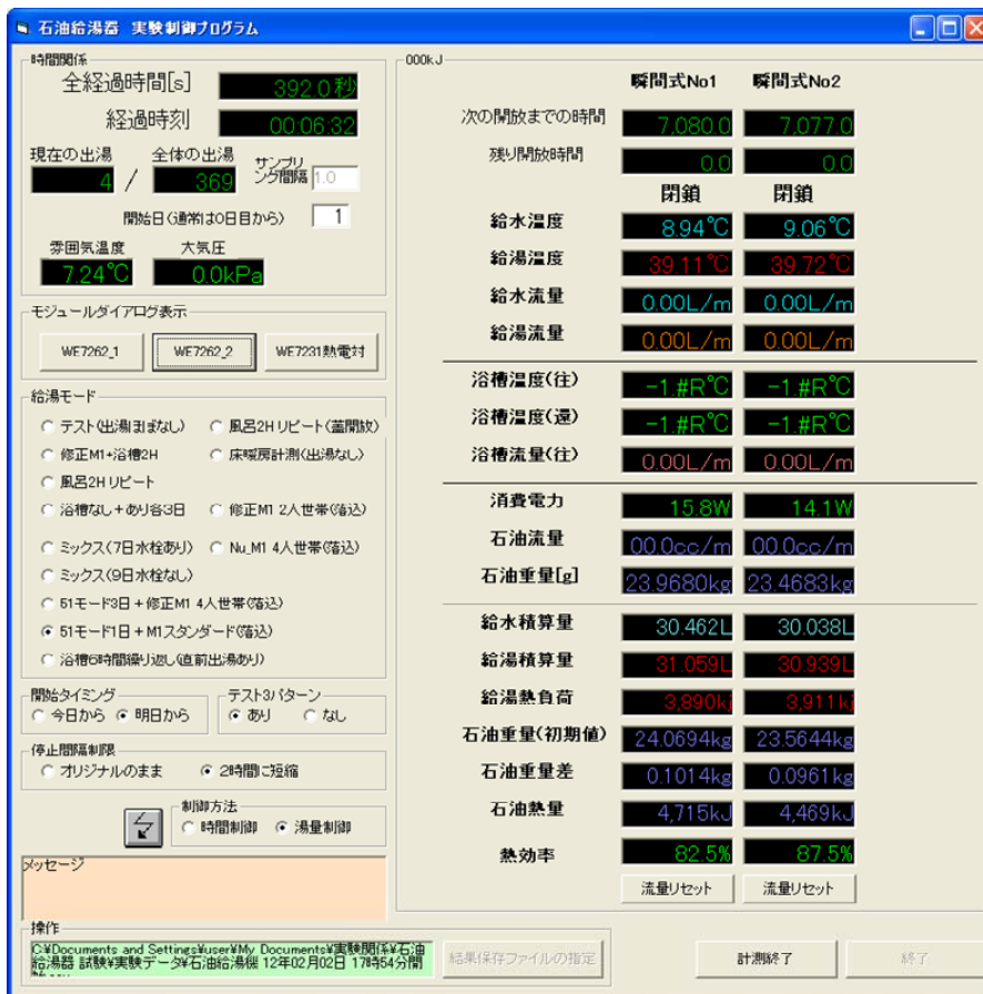
図 3.3.82 石油瞬間式の計測プログラム
