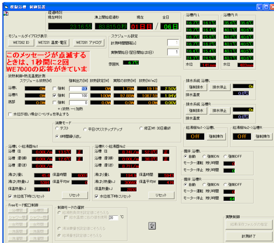
図 3.3.66 模擬浴槽の制御プログラム
