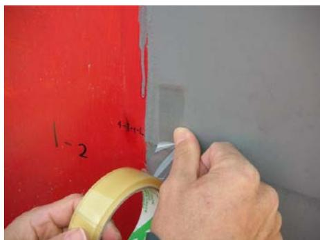
図-3.6 基盤目試験状況
