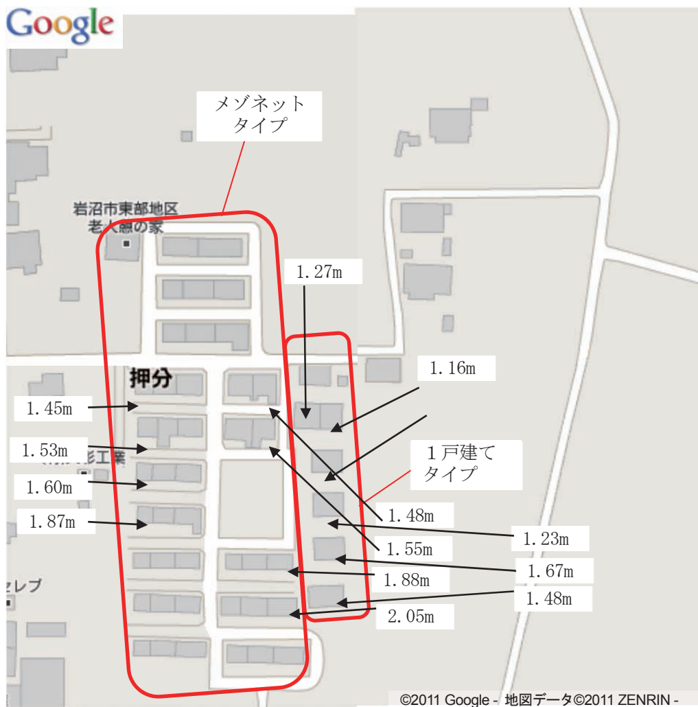
図D-4.1 岩沼市林住宅の住戸の配置 (図中の数字(m)は測定された浸水深)
