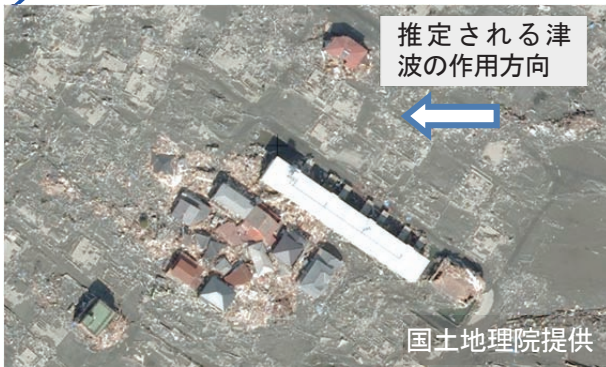
写真 6. 4. 1-3 津波の入射方向に建つ建築物により津波波力が軽減し、残存したと考えられる例 (名取市関上地区)
