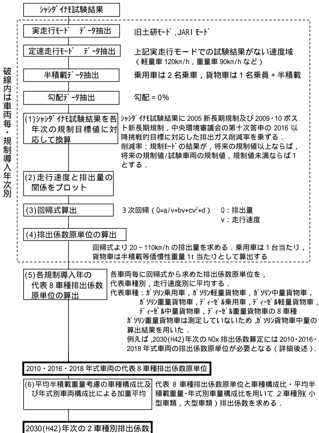
図5.1 道路環境影響評価に用いる自動車排出係数の算定フロー（2030年次のNOx排出係数の場合）
