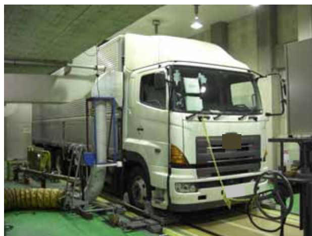
図 2.1 シャシダイナモメータを用いた自動車排出ガス量測定試験の実施状況
