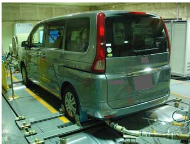
図 2.1 シャシダイナモメータを用いた自動車排出ガス量測定試験の実施状況
