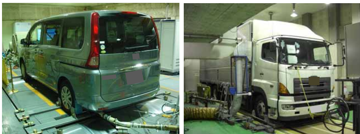
図 2.1 シャシダイナモメータを用いた自動車排出ガス量測定試験の実施状況
