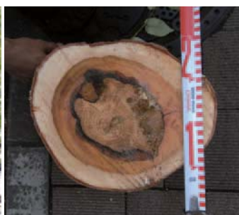
④切断した枝の腐朽状況
