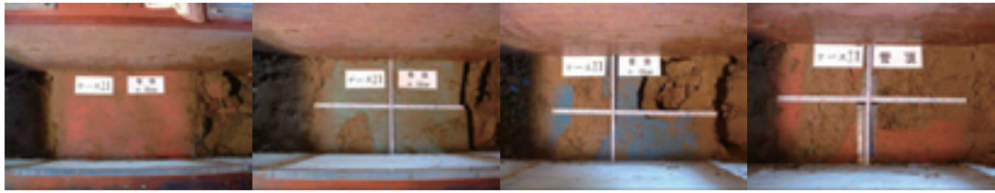
写真-4.10 case7 ゆるみ観測状況(管頂 30、20、10、0cm)
