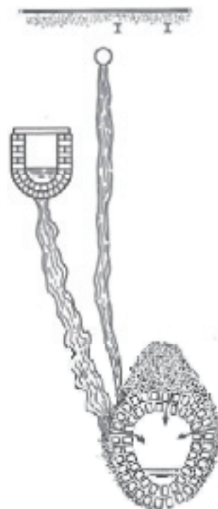
図-4.6 英国レンガ管崩壊メカニズムの概念図
