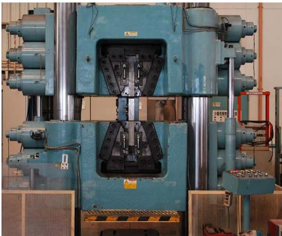
写真 3-1 4000KN 引張試験機での試験状況
