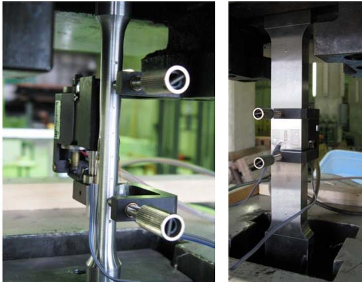
写真 2 2000kN 引張試験機での試験状況
