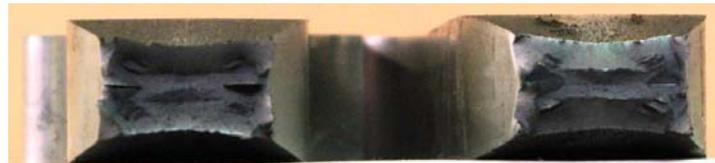
写真 4-4 (a) SA440C t25 1A 号 (左 : 板幅側、右 : 板厚側、下 : 311 試験片の破断面)
