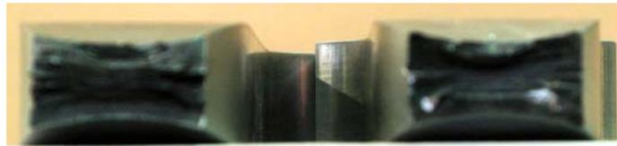
写真 4-5(a) H-SA700B t25 1A号(左：板幅側、右：板厚側、下：411 試験片の破断面)
