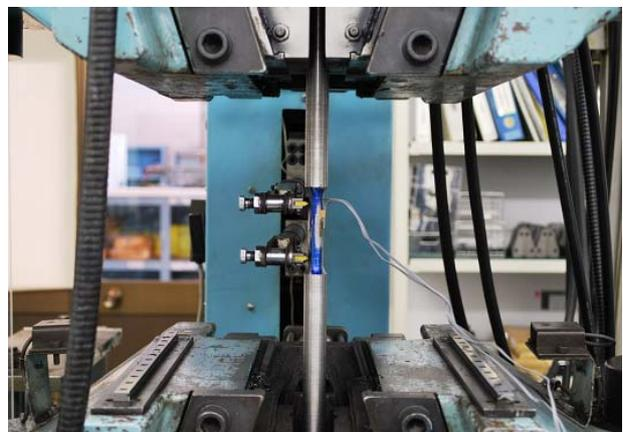
写真 3-2 500KN 引張試験機での試験状況
