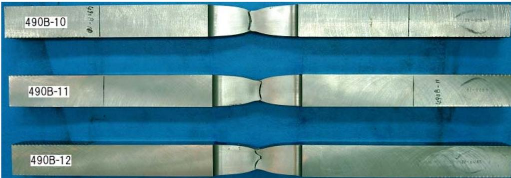
写真 5-4 SN490B t40 12A号試験片
