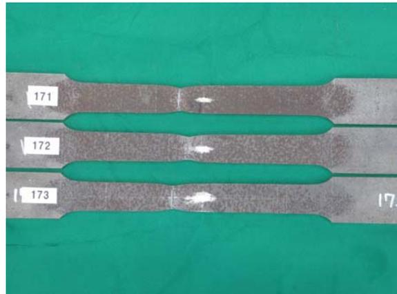
写真 4-2 (d) SN490B t9 14B 号
