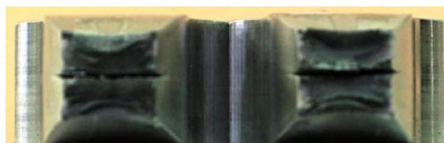
写真 4-5(c) H-SA700B t25 5号(左：板幅側、右：板厚側、下：441 試験片の破断面)
