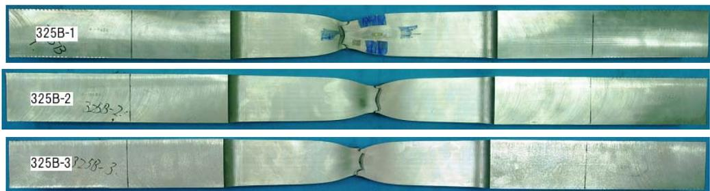
写真 6-1 TMCP325B t60 1A号試験片
