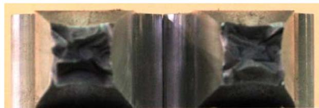
写真 4-4 (c) SA440C t25 5 号 (左 : 板幅側、右 : 板厚側、下 : 341 試験片の破断面)
