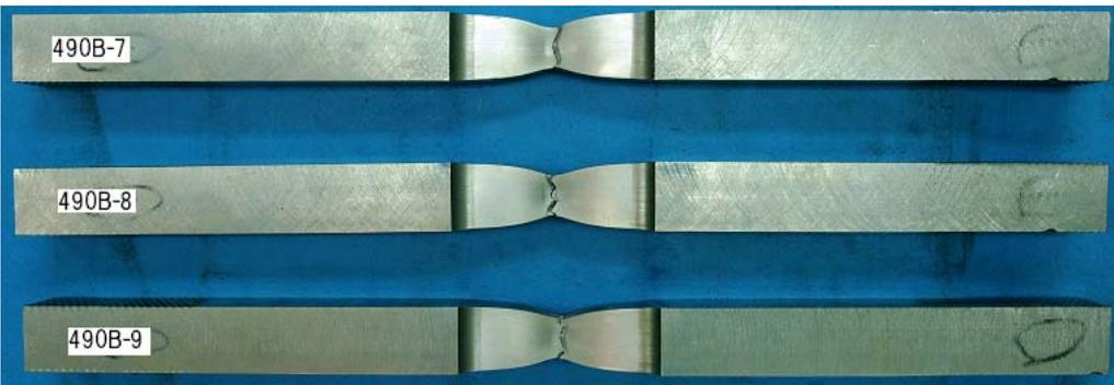
写真 5-3 SN490B t40 5号試験片
