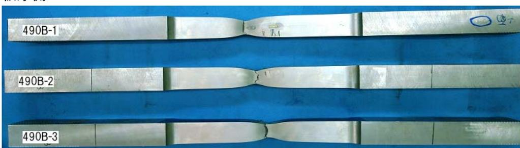
写真 5-1 SN490B t40 1A 号試験片
