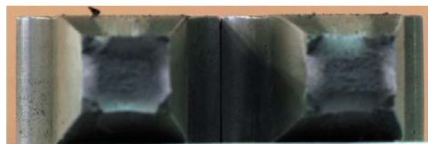
写真 4-3 (c) SN490B t25 5 号 (左 : 板幅側、右 : 板厚側、下 : 241 試験片の破断面)
