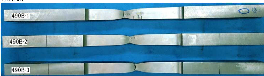
写真 5-1 SN490B t40 1A 号試験片
