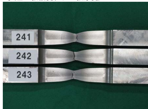
写真 4-3 (b) SN490B t25 1B 号 (左 : 板幅側、右 : 板厚側)
