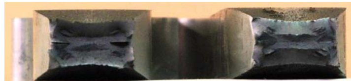
写真 4-4 (a) SA440C t25 1A 号 (左 : 板幅側、右 : 板厚側、下 : 311 試験片の破断面)
