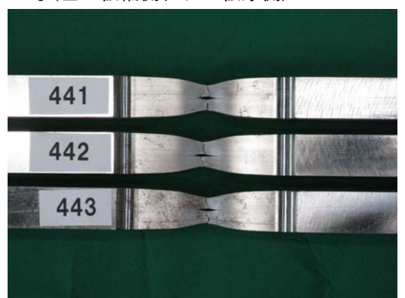
写真 4-5(b) H-SA700B t25 1B号(左：板幅側、右：板厚側)
