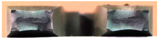
写真 4-3 (a) SN490B t25 1A 号 (左 : 板幅側、右 : 板厚側、下 : 211 試験片の破断面)
