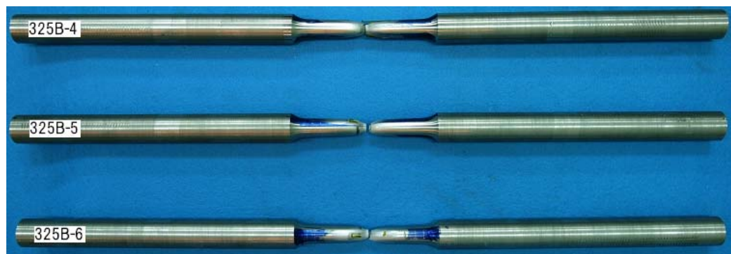
写真 6-2 TMCP325B t60 4 号試験片
