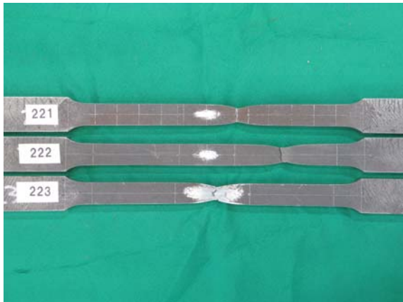
写真 4-3 (b) SN490B t25 1B 号 (左 : 板幅側、右 : 板厚側)
