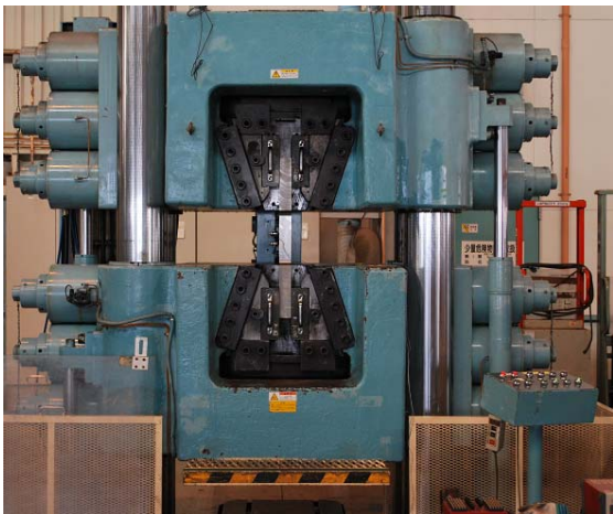
写真 3-1 4000KN 引張試験機での試験状況
