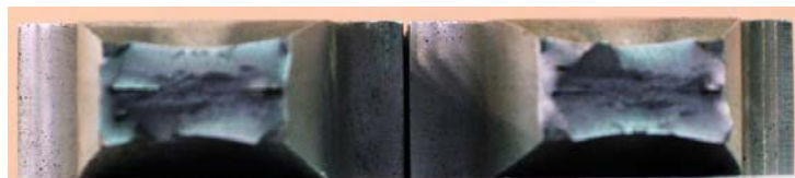
写真 4-3(f) SN490B t25 12C 号(左 : 板幅側、右 : 板厚側、下 : 291 試験片の破断面)
