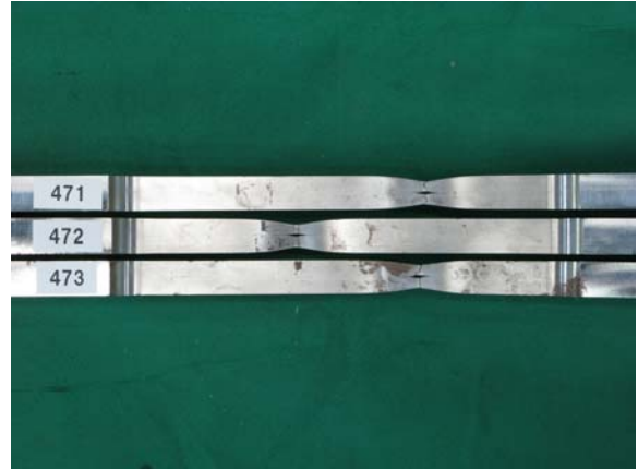
写真 4-5(d) H-SA700B t25 14B 号(左 : 板幅側、右 : 板厚側)
