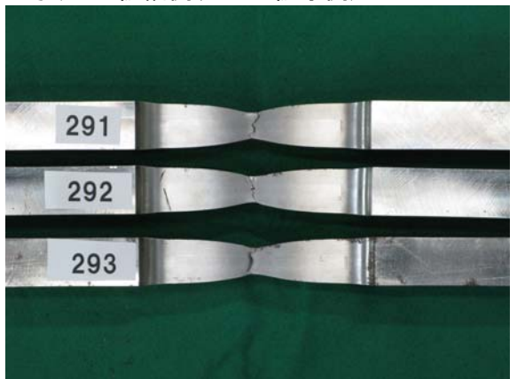
写真 4-3(e) SN490B t25 12A 号(左 : 板幅側、右 : 板厚側)
