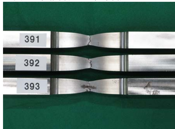
写真 4-4 (e) SA440C t25 12A 号(左 : 板幅側、右 : 板厚側)
