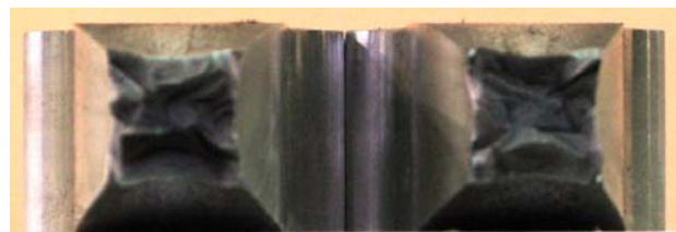
写真 4-4 (c) SA440C t25 5 号 (左 : 板幅側、右 : 板厚側、下 : 341 試験片の破断面)
