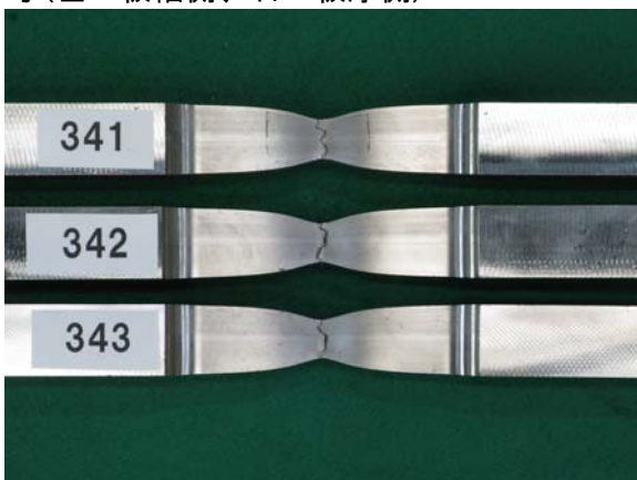
写真 4-4 (b) SA440C t25 1B 号 (左 : 板幅側、右 : 板厚側)
