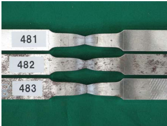
写真 4-5(e) H-SA700B t25 12A 号(左 : 板幅側、右 : 板厚側)
