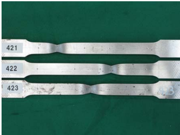
写真 4-5(b) H-SA700B t25 1B号(左：板幅側、右：板厚側)
