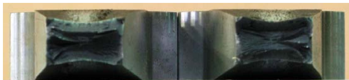
写真 4-4 (f) SA440C t25 12C 号(左 : 板幅側、右 : 板厚側、下 : 391 試験片の破断面)
