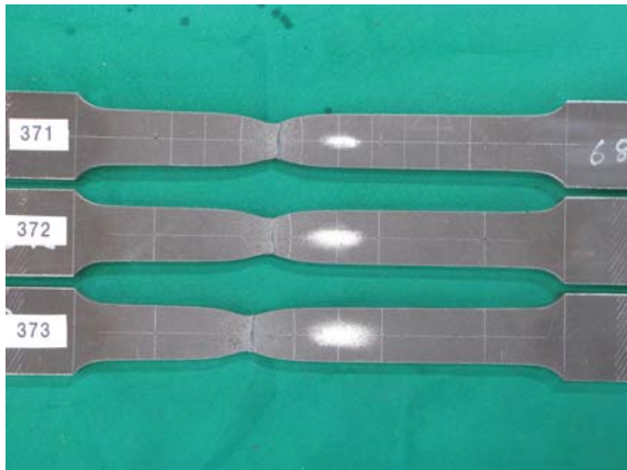
写真 4-4 (d) SA440C t25 14B 号(左 : 板幅側、右 : 板厚側)
