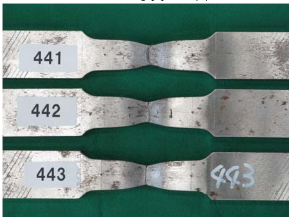
写真 4-5(b) H-SA700B t25 1B号(左：板幅側、右：板厚側)
