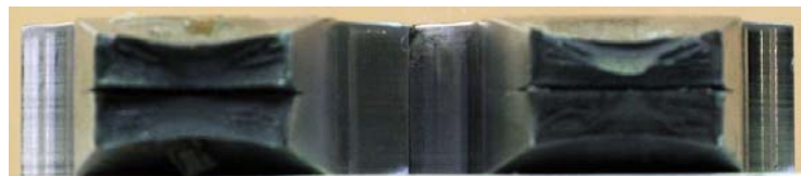
写真 4-5(f) H-SA700B t25 12C 号(左 : 板幅側、右 : 板厚側、下 : 491 試験片の破断面)
