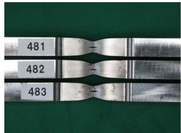
写真 4-5(e) H-SA700B t25 12A 号(左 : 板幅側、右 : 板厚側)
