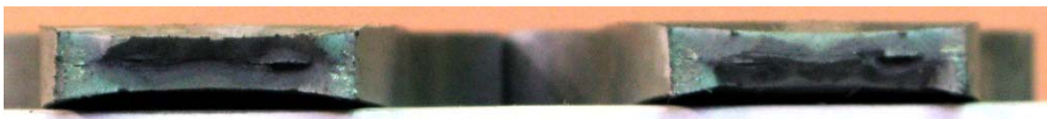
写真 4-2 (f) SN490B t9 12C 号 (下は 191 試験片の破断面)
