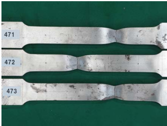
写真 4-5(d) H-SA700B t25 14B 号(左 : 板幅側、右 : 板厚側)
