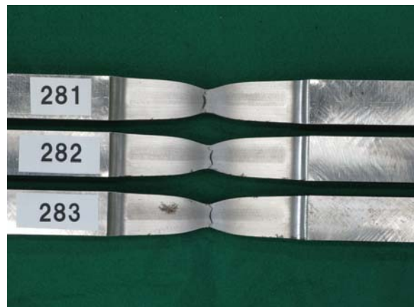
写真 4-3(e) SN490B t25 12A 号(左 : 板幅側、右 : 板厚側)
