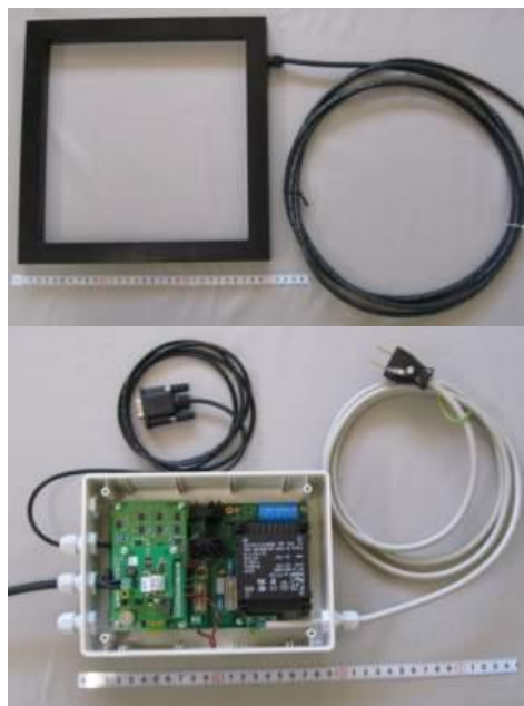
図4 記録型マイクロチップリーダー 上：マイクロチップリーダーアンテナ部 縦50 cm×横50 cm 下：マイクロチップリーダー記録部
