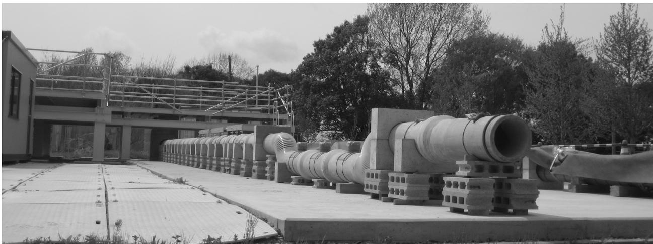
写真-3 模擬劣化管路外観
