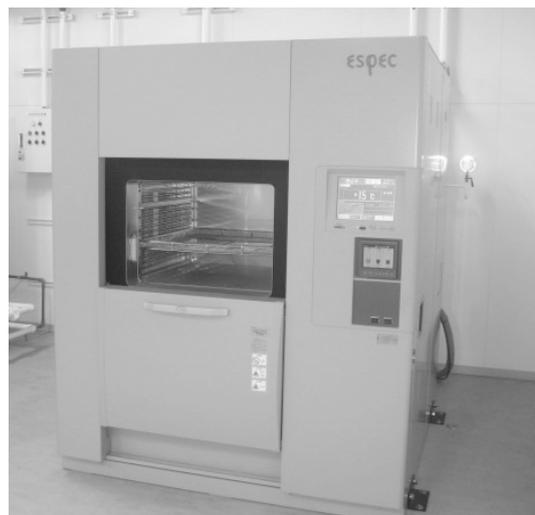
写真－４ 冷熱衝撃装置
