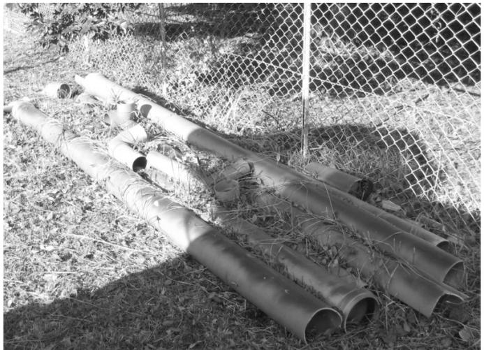
写真－2 露出管（約 15 年間屋外曝露）
