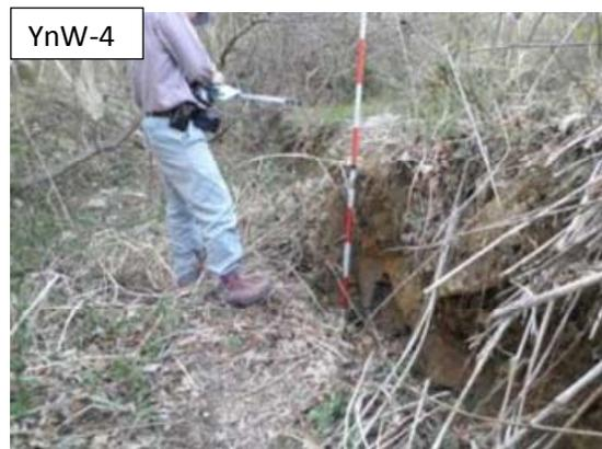
碎石場南側の切り土のり面上部に現れた断層。走向N41W、垂直変位量70cm、開口幅30cm。青灰色の柔らかい粘土は断層粘土の可能性はある。(写真左手の露頭では白色の凝灰岩が観察される。)
