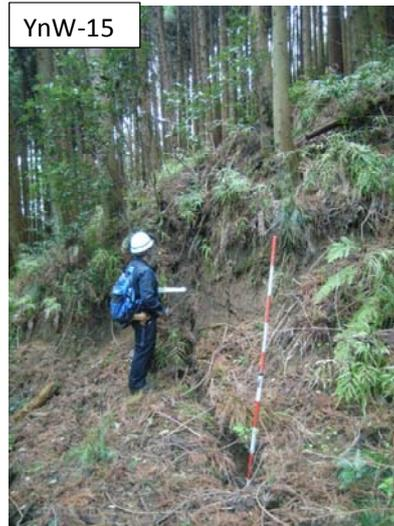
YnW-15地点西側の確認地点。北を望む。走向はN55W。写真手前側の里道面での垂直変位量は最大で30cm。
